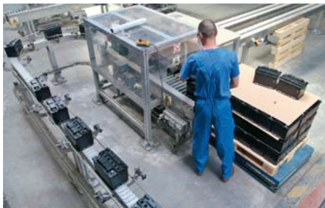
Podczas produkcji akumulatorów Exide wykorzystywane są opatentowane przez koncern rozwiązania, dlatego w wielu miejscach zakładu obowiązuje zakaz wykonywania zdjęć. Tu jeden z końcowych etapów – składowanie akumulatorów na paletach
